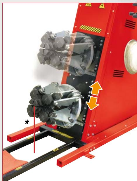
Il gruppo mandrino è in grado di muoversi sia in senso orario che antiorario, ma anche verso l'alto e il basso. Il dispositivo di bloccaggio è stato progettato per consentire l'aggrappamento di qualsiasi genere di ruota.
