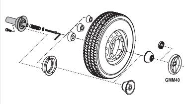
► **UC215/HW:** flangia con volantino GMM40 ed albero Ø 40mm con 4 coni, per vetture e veicoli commerciali leggeri (Ø 43-180 mm).
