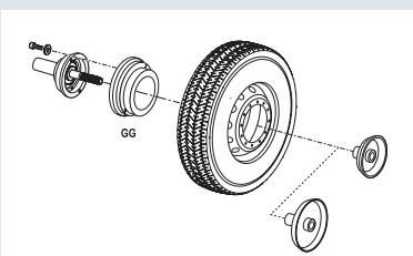
► **KIT IV - V - GG:** due coni e un distanziale per ruote di veicoli pesanti per UC215/HW (Ø 202-221-281 mm).
