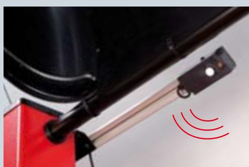
Sistema di misurazione dell'eccentricità (Prima Armonica e Picco-picco) della ruota con Sonar. Si attiva automaticamente durante il ciclo di equilibratura, così che l'operatore possa avere, senza perdita di tempo, informazioni circa l'entità e la posizione dell'eccentricità sulla ruota, migliorando la qualità del servizio.
