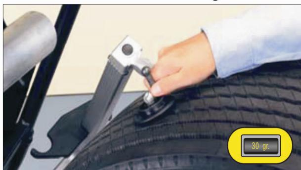
Bu özellik ağır lastiklerde çok kullanılmaktadır. 4x4 lastikler gittikçe büyümekte ve ağırlaşımaktadır. Bu tip lastiklerde balans kurşunlarında mecburen çok büyük takılmaktadır. Ağırlıklı yama kullanılarak ekonomi sağlanabilir.
