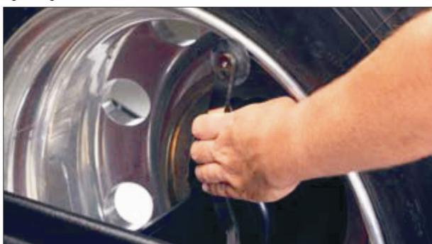
İç ölçüm kolu balans kurşununun koyulacak yerini tespit eder ve iç ölçüyü otomatik alır. 30" e kadar ölçüm yapar.
